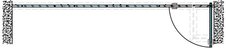
2.- Levantar pasadores (dos por panel). Los paneles abatibles con mecanismos de puerta no llevan pasador a suelo ya que se fijan mediante manivela-cerradero.
